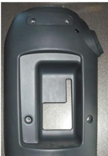
**Dépose de la partie inférieure sous le volant. 4 vis classiques.**
