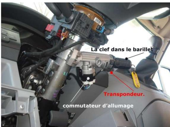
Sur cette photo on reconnaît la clef, le bloc attaché sur le volant (*le neiman*), une prise électrique (*le commutateur d'allumage*) et le « transpondeur » (*pour faire simple*). C'est lui qui lit le code de la clef.
