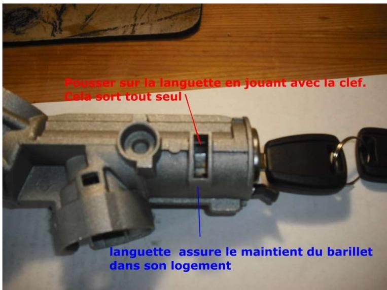
Le barillet se dépose en insérant la clef, et en enfonçant la languette qui se trouve dans ce logement.
